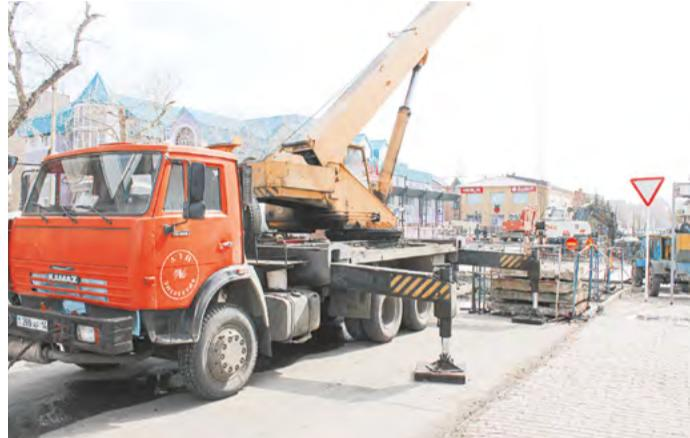
закрепления на них участков труб, каждый по шесть метров, по приезде на место проведения ремонтов, персонал выгружает трубы с помощью встроенного крана, тут же могут «отрезать» необходимую часть и приступить к монтажу, все это благодаря сварочному агрегату и генератору, которые имеются на борту. Вентиляционная
